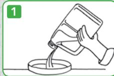
1 Vider le contenu dans le réservoir du pulvérisateur, en le tournant de sorte que le produit se trouvant dans la poignée puisse s'écouler.
