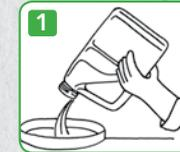
1 Vider le contenu dans le réservoir du pulvérisateur, en le tournant de sorte que le produit se trouvant dans la poignée puisse s'écouler.
