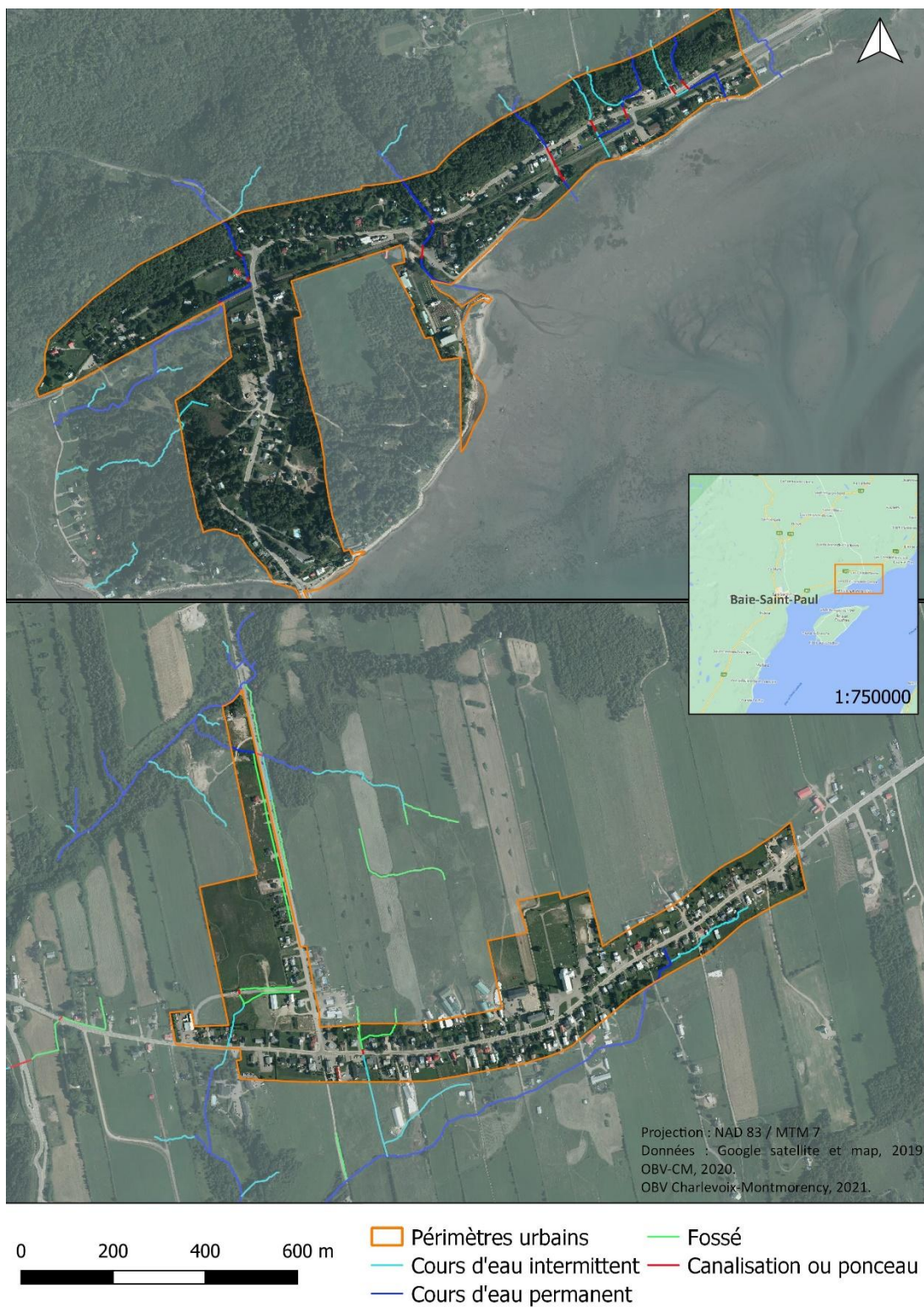
Figure 44.. Lits d'écoulements dans les périmètres urbains de la municipalité des Éboulements.
