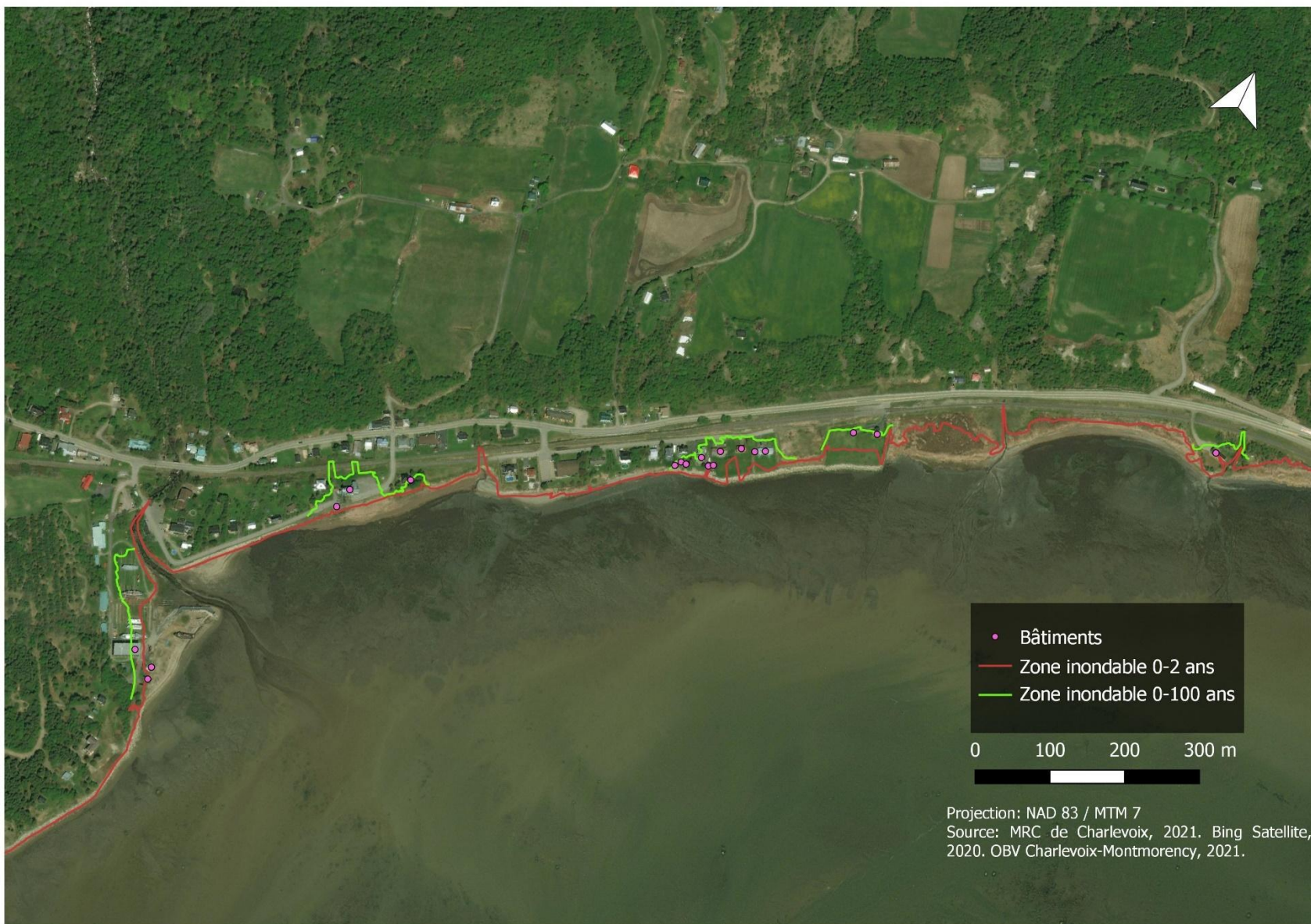
Figure 16. Bâtiments dans la zone inondable 0-100 de la municipalité des Éboulements, à Saint-Joseph-de-la-Rive.
